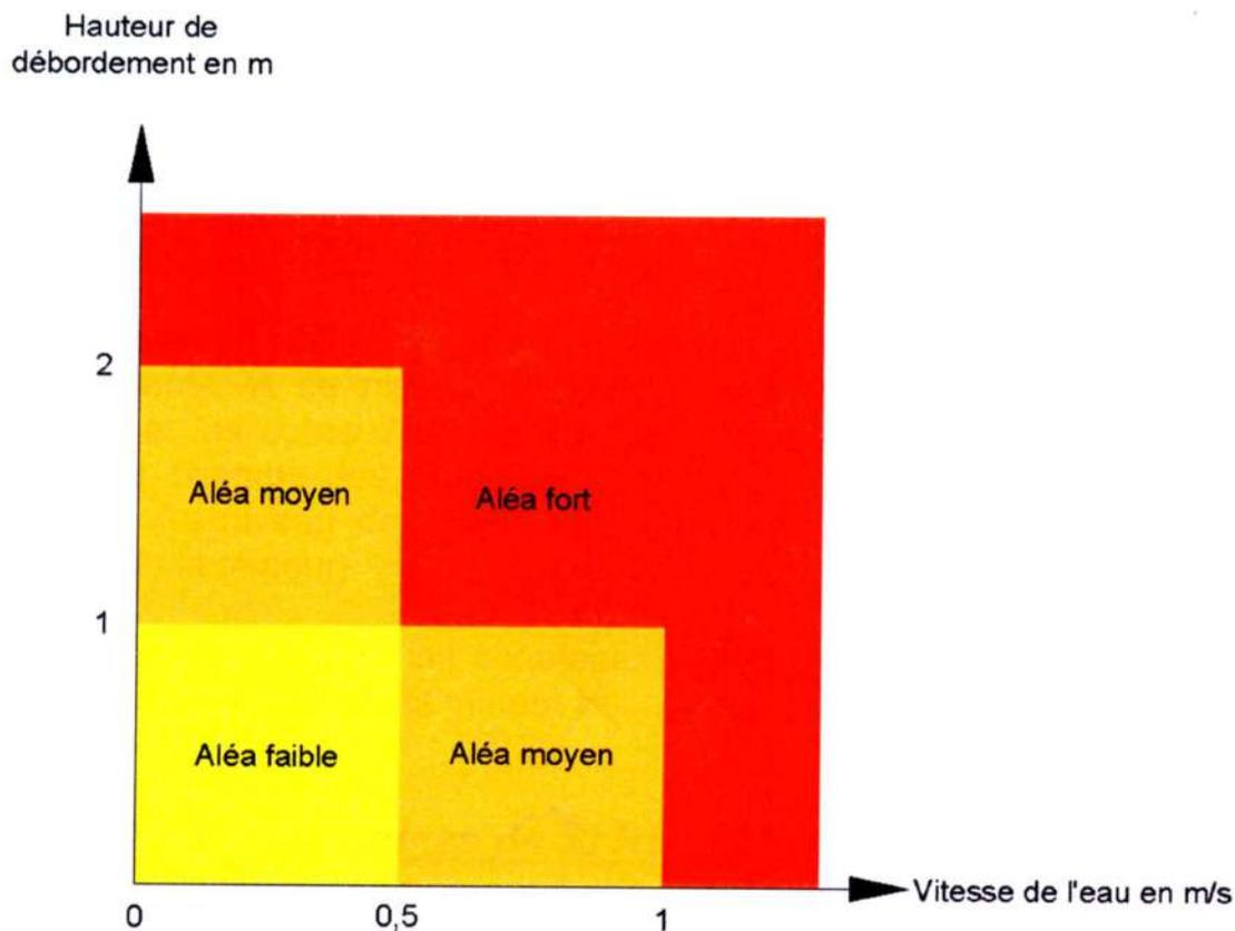
Au niveau du bassin de l'Ay, le facteur le plus contraignant est la vitesse des écoulements. En effet, comme le montre le graphique, au-dessus de 0,5 m/s, l'aléa est affiché comme moyen et au-dessus de 1 m/s, il est affiché comme fort. Les calculs hydrauliques montrent que les écoulements sur les lits majeurs de l'Ay et de ses affluents possèdent des vitesses généralement proches ou supérieures à 1 m/s, ce qui conduit à classer en zone d'aléa fort une large partie de la zone inondable
